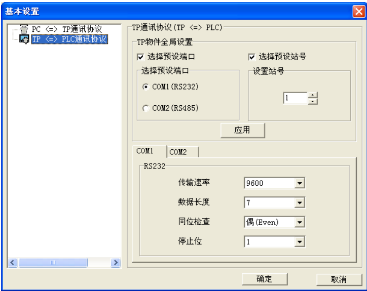
图 3-14 TP<=>PLC 通讯协议
